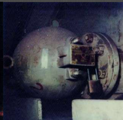
Incinerator waste level control ^{137}\text{Cs} : 1 GBq
